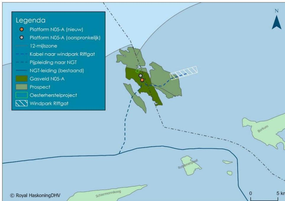
Abbildung 1. Erdgasfeld N05-A, ursprünglicher und neuer Standort der Bohr- und Förderplattform, einschließlich der Lage der Gasfelder und der neuen Trassen der Gaspipeline und des Kabels des Windparks Riffgat.
